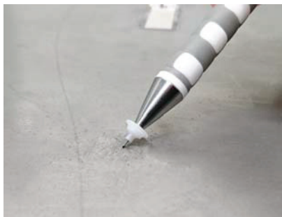
Abbildung 1: Hsu-Nielsen-Quelle mit einem Minendurchmesser von 0,5 mm und dem Härtegrad H2.
