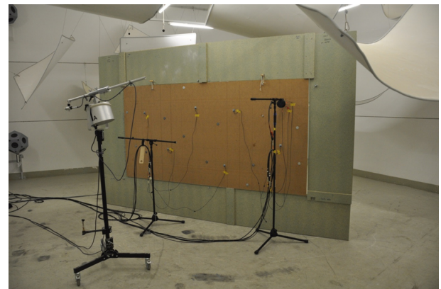
Abbildung 2: Messaufbau beim Hallraum-Verfahren, die Platte schwingt frei und ist von einem Baffle umgeben. Anregung hier mit einem elektrodynamischen Shaker (direkte Methode), im Hintergrund Dodekaeder zur Anregung des Raumes (indirekte Methode). Vorne im Bild das verwendete Schalldruck-Mikrofon auf dem Drehgalgen.
