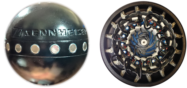
Abbildung 1: Außen- und Innenansicht des MTB-Mikrofonarrays
