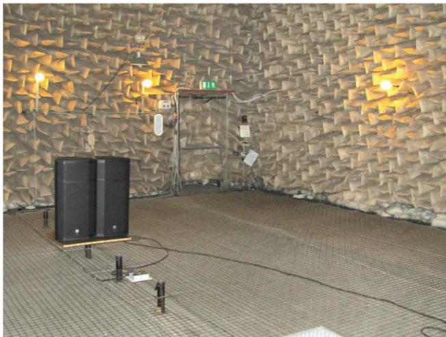
Abbildung 2: Vermessung der 2 Hochleistungs-lautsprecher im Großen Reflexionsarmen Raum der TU Dresden.
