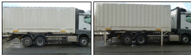
Abbildung 8-9: Hochfahren des Fahrgestells mit der Wechselbrücke mit Hilfe von Pneumatik (linke Abbildung), Abstellen der Wechselbrücke und Abfahrt des LKW ohne Wechselbrücke (rechte Abbildung).
