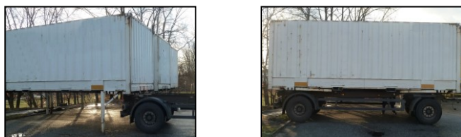
Abbildung 6-7: Unterfahren der Wechselbrücke mit dem Fahrgestell (linke Abbildung), Wechselbrücke und Fahrgestell auf Fahrstellung absenken (rechte Abbildung).
