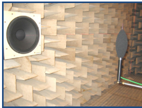
Abbildung 2: Der Frequenzgang eines Außenmikrofons wird im reflexionsarmen Raum vermessen.
