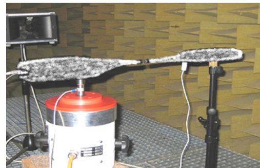
Abbildung 5: Auch die Funktion des Schallpegelmessers bei verschiedenen Umgebungsbedingungen muss getestet werden.
