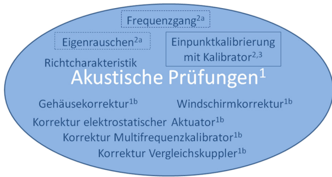
Abbildung 1: Die akustischen Prüfungen sind das Kernstück der Schallpegelmessprüfung bei Baumusterprüfung und periodischer Prüfung.
