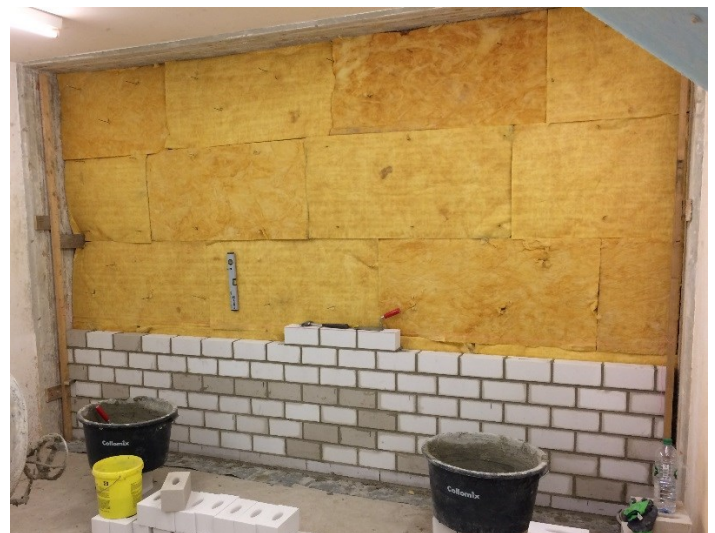
Abbildung 1: Einbau der Verblendschale in den Wandprüfstand
