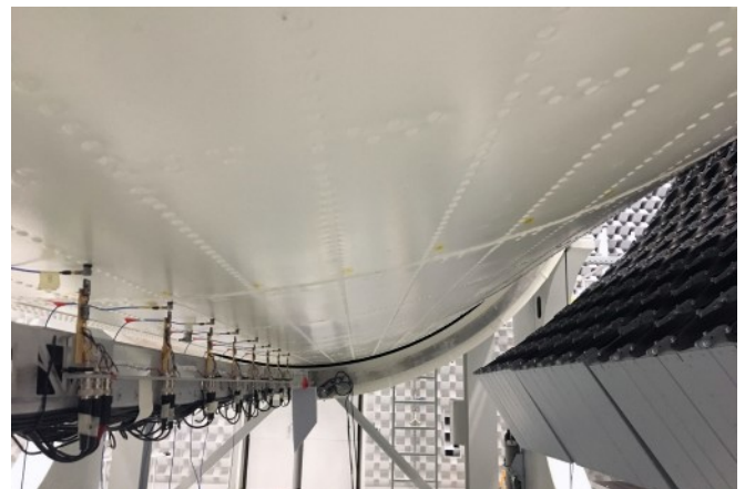
Abbildung 4: Acoustic Flight LAB Demonstrator im reflexionsarmen Raum des ZAL TechCenter mit Sensorik und Lautsprecher-Array.
