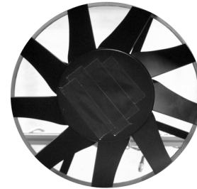
Abbildung 1: Referenzventilator mit gerader Vorderkante; Drehrichtung: Uhrzeigersinn.
