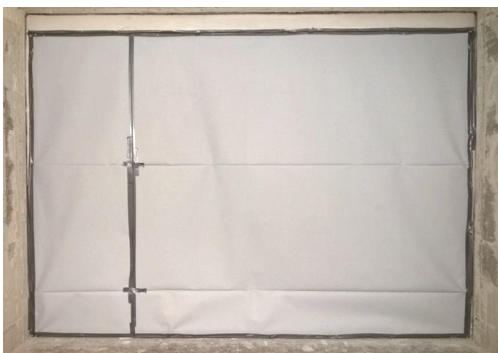
Abbildung 1: doppelschaliger Trennvorhang (zwei Lagen je 1200 \text{ g/m}^2 im Abstand von 26 cm) eingebaut im Wandprüfstand.
