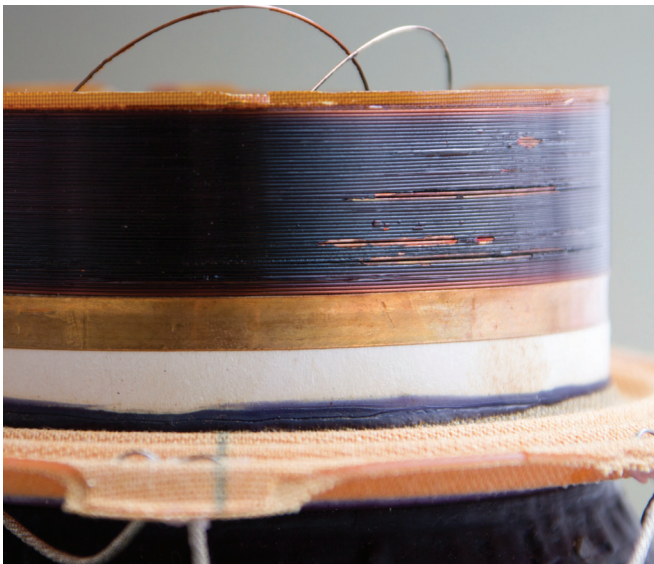
Abbildung 1: Fotografie einer durch Temperatureinwirkung zerstörten Schwingspule
