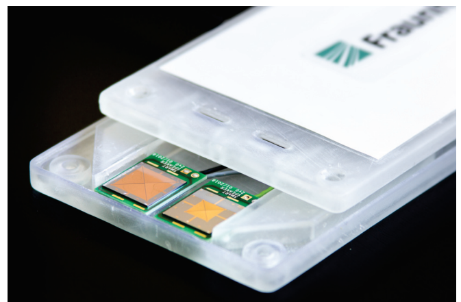
Abbildung 2: MEMS-Woofer und -Tweeter im Einbauzustand in einem 3D-gedruckten Smartphone-Gehäuse.
