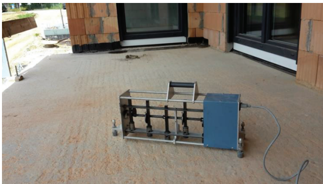
Abbildung 1: Aufstellung des Hammerwerks auf der untersuchten Balkonplatte
