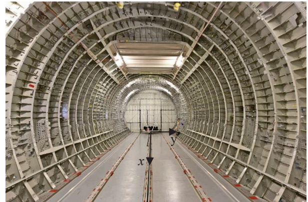
Abbildung 2: Messumgebung mit dem in x -Richtung verfahrbaren Mikrofonstell im Hintergrund
