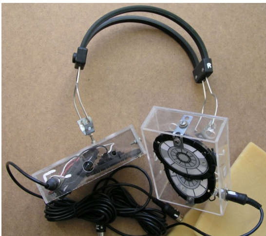
Abbildung 1: Der erste 4-Kanal-Kopfhörer als Funktions-Prototyp (1988) für Monitoring-Zwecke im eigenen Tonstudio für elektronische Musikaufnahmen [3] mit vorgeschaltetem Equalizer zur Klangbild-Entzerrung.
