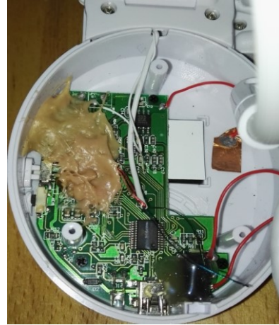
Abbildung 8: Fotografische Einsicht in eine Kopfhörer-Kapsel des SFERICS-HEADPHONES SH-S1 [7] mit zusätzlicher Wechselfeld-Erzeuger-Elektronik (Prototyp 2017).
