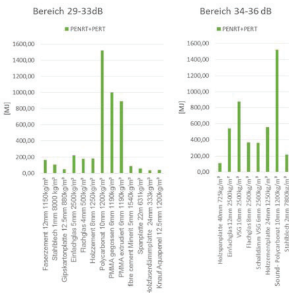
Abb. 5: Gesamtenergiebedarfe aus Total nicht-erneuerbar Primärenergie (PENRT) + Total erneuerbar Primärenergie (PERT) pro m 2 Plattenwerkstoff für 29-33 dB und 34-36 dB – Betrachtungsrahmen 25 Jahre
