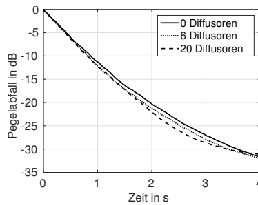
Abbildung 4: Abklingvorgang mit 0, 6 und 20 Diffusoren bei f = 125 Hz im Hallraum mit 12 \text{ m}^2 Absorber
