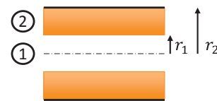
Abbildung 5: Schematischer Aufbau eines Absorptionsschalldämpfers. Im Bereich 0 < r \leq r_1 befindet sich Luft und im Bereich r_1 < r \leq r_2 Absorptionsmaterial.
