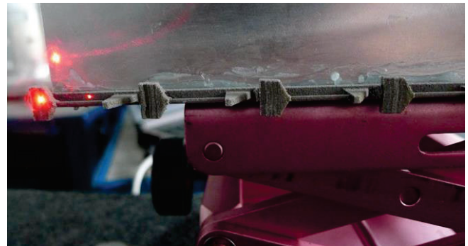
Abbildung 4: Messung an Mikrotilgergeometrie mit Laservibrometer (Typ B - rechteckiger Biegebalken mit Endmasse).
