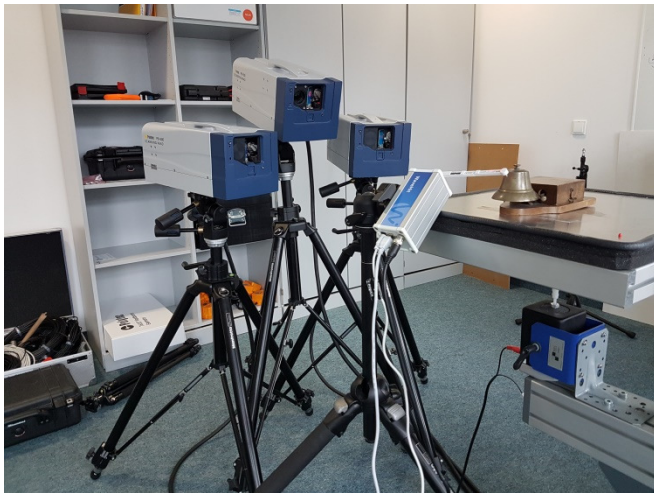
Abbildung 3: Versuchsaufbau zur modalen Vermessung einer 100 Jahre alten Türglocke mit dem PSV-500 3D Scanning System der Firma Polytec GmbH
