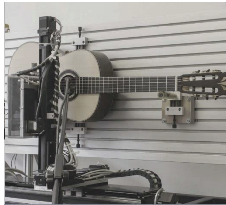
Abbildung 2: Anzupfversuche mit einer automatischen Vorrichtung zur Ermittlung der Ansprache (Attack) und des Ausklingverhaltens (Sustain) am Beispiel von Klassikgitarren
