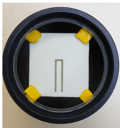
Abbildung 4: Befestigung des Resonators im Impedanzrohr.
