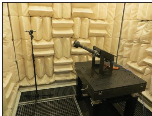
Abbildung 1: Messdurchführung im reflexionsarmen Schallmessraum.
