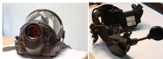
Abbildung 1: Beispiel für eine Atemschutzmaske (links) mit zugehöriger Kommunikationseinheit (rechts).
