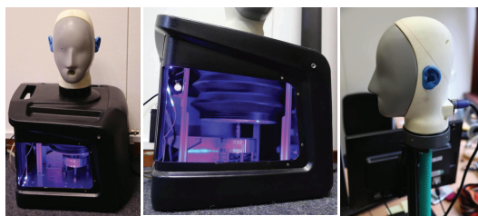
Abbildung 2: Blasebalg mit Kunstkopf (links), Detailansicht Blasebalg (mitte) und entkoppelter Kunstkopf mit Zuführungsschlauch (rechts).
