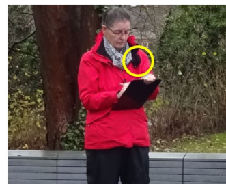
Abbildung 3: Zur Aufzeichnung des LAeq wurde vom Leiter jeder Gruppe an der Schulter ein DoseBadge der Firma Cirrus getragen.
