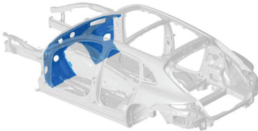
Abbildung 1: Stirnwand im Rohbau eines Porsche Panamera
