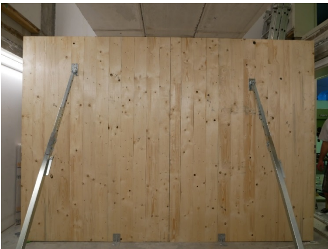
Abbildung 3: Einbau der Brettsperrholzwand im Deckenprüfstand der HFT Stuttgart.
