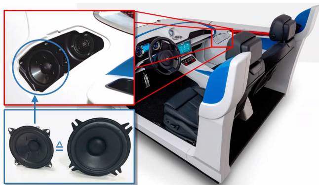
Abbildung 3: Aufbau des Sitzkasten-Demonstrators. Der Ausschnitt oben links zeigt das 2-Wege-System der Beifahrertür mit abgenommenem Schutzgitter. Mittels Linearisierung soll der 10-cm-Tieftöner im Kasten unten links ein „unbehandeltes“ 13-cm-Chassis ersetzen.
