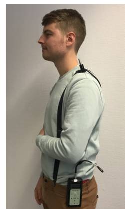
Abbildung 1: An ein Hosenträger fixiertes Mikrofon eines Schallexposimeters zur Gewährleistung der korrekten Messposition nach [5].
