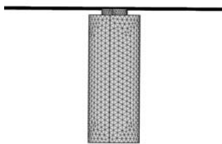
Abbildung 3: Resonator mit Ebene in Höhe des oberen Halsabschlusses und BEM-Netz.
