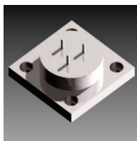
Abbildung 3: Versuchsaufbau für konventionelle Schallgeschwindigkeitsmessungen mit definiertem Abstand zwischen Stäbchenoberfläche und Rückwand.
