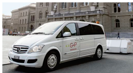
Abbildung 2: Zugfahrzeug mit Messanhänger CPX
