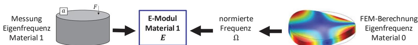
Abbildung 2: Bestimmung des E-Moduls mittels Eigenfrequenz-Verfahren; schematische Darstellung
