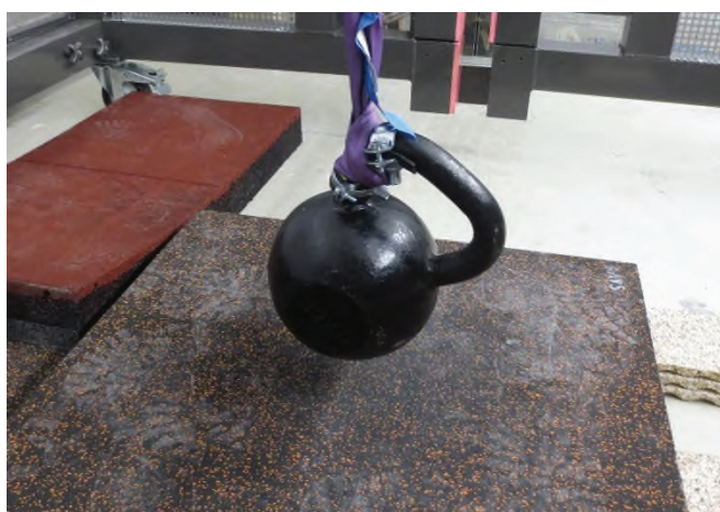
Abbildung 2: An Rundschlinge aufgehängte Kugelhantel als Trittschallquelle für Fitnessböden.
