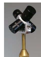
Abb. 3 Als Tetraeder angeordnete Richtmikrofone.
