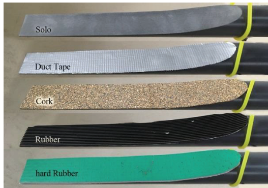
Abbildung 2: Entsprechend dem ABH-Effekt abgeflachtes Stabende mit verschiedenen dämpfenden Materialien
