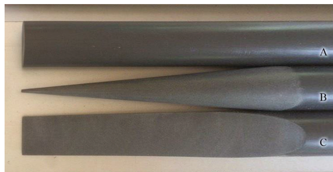
Abbildung 1: Änderung der Querschnitte, unbearbeitetes Ende A, spitz zulaufend B und abgeflacht entsprechend ABH-Effekt C
