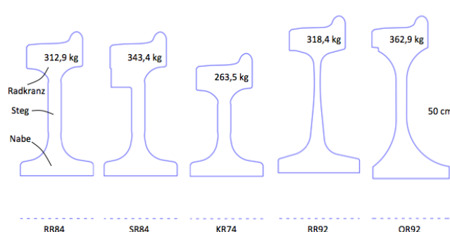
Abbildung 1: Maßstäbliche Querschnitte der untersuchten Räder und ihre Massen; die gestrichelte Linie stellt die Rotationsachse des Rades dar
