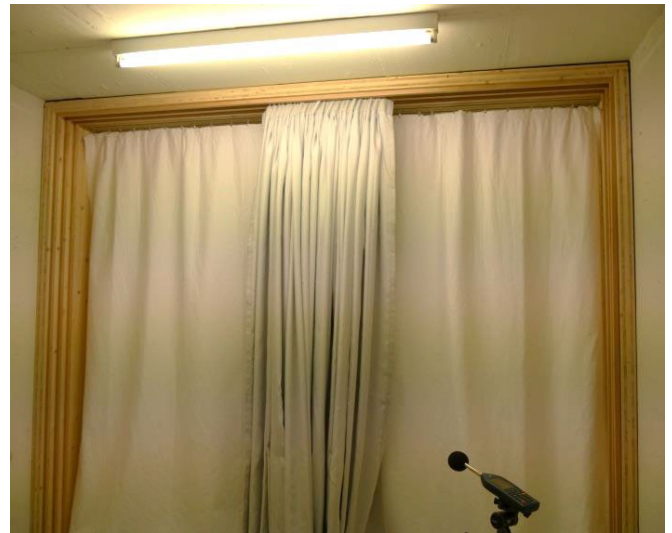
Abbildung 3: Vorhangprüfstand der Hochschule Luzern, T&A. Der Prüfstand erlaubt das Messen mehrlagiger Vorhangsysteme mit unterschiedlichen Abständen zwischen den Lagen. Jede Lage kann schalldicht zur Wand, zur Decke und zum Boden eingespannt werden. Jede Lage kann mit beliebiger Spaltbreite zur Wand geöffnet werden.
