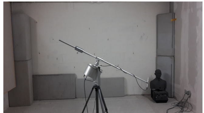
Abbildung 2: Empfangsraum aus Sicht der Trennwand (Raummitte: Mikrofon mit Schwenktrippel; hintere rechte Ecke: Kunstkopf mit binauralem Headset; Raumecken: Eckabsorber zur Reduzierung der Nachhallzeit).
