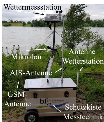
Abbildung 1: Mobile Messeinrichtung zur Erfassung von Schiffsschall.
