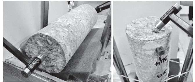
Abbildung 7: Bestimmung des E-Moduls durch Eigenfrequenz-Messungen entsprechend [4]; links: Messung der Longitudinal-Eigenfrequenz; rechts: Messung der Torsions-Eigenfrequenz
