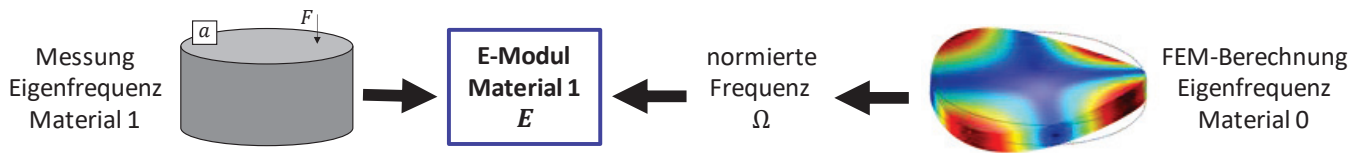
Abbildung 9: Bestimmung des E-Moduls mittels des Eigenfrequenz-Verfahrens aus [4]
