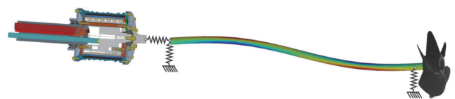
Abbildung 2: Schematische Darstellung des Antriebsstranges mit Motor, Welle, Lagern und Propeller.
