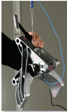
Abbildung 7: Versuchsaufbau der experimentellen Modalanalyse an der Drehmomentstütze mit der Methode „wandernder Hammer“. Der Referenzpunkt wurde ausgehend von einem numerischen Modell durch das vorgestellte Verfahren als optimal geeignet ermittelt.
