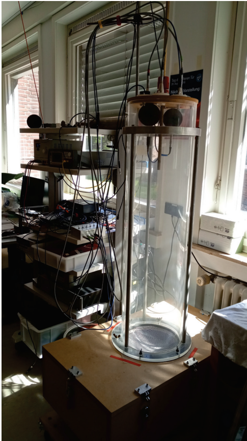
Abbildung 2: Messaufbau zur Sekundärkalibrierung von Messmikrofonen und Schallpegelmessern im Infraschallbereich. Die Anregungsquelle befindet sich am Boden der Acrylglasröhre, Referenz und Prüfling im Bereich des Deckels.
