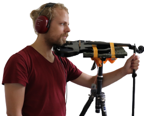
Abbildung 4: Ein Proband am Versuchsaufbau. Nachdem die Violine korrekt positioniert war, wurde die Schulterstütze entfernt und die linke Hand an einem zusätzlichen Ständer, statt am Hals der Violine platziert.
