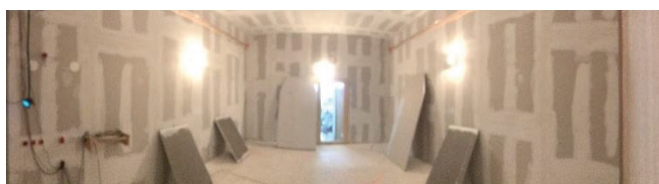
Abbildung 3: SR-Variante SR02: zweite Ausbaustufe der Diffusoren, mit drei Diffusoren je 1 m 2 in Anlehnung an EN ISO 16283-1 sowie zwei Diffusoren mit je knapp 3 m 2 wie im CEN-Ringversuch [2] verwendet
