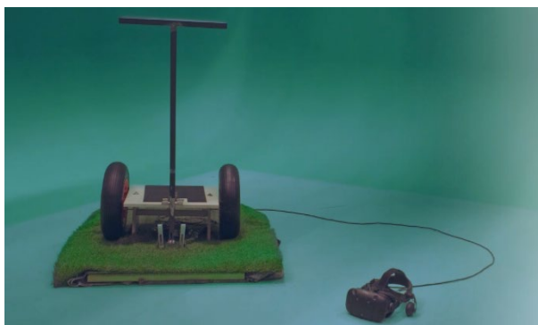
Abbildung 1: Segway-Simulator mit zugehörigem VR-Equipment. (Quelle: Spies N., Gökcen N., 2019) [2]
