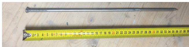
Abbildung 1: Zur Verschraubung der Konterlattung eingesetzte Doppelgewindeschrauben
