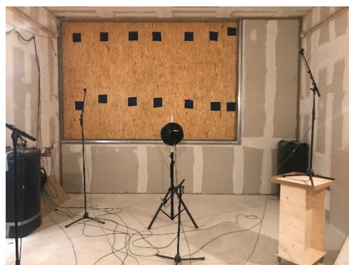
Abbildung 2: In die Adapterwand eingebaute Holzrahmenwand im XL-PS
