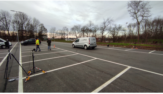
Abbildung 1: Messaufbau: Vorbeifahrt bei konstanten 30 km/h, Schallpegelmessler links und rechts im Abstand von 7,5 m, Messstrecke von 20 m.
